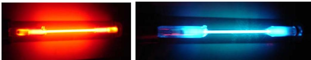
圖 22.1.1~2 不同的氣體放電管，顏色與管內氣體的種類有關
