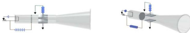
4.陰極射線的本質與產生：帶負電的質點由陰極射出，往陽極運動，因空氣分子少，在管中容易加速。
