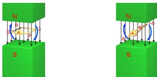
觀察結果：當線圈在磁場中旋轉，產生感應電流
