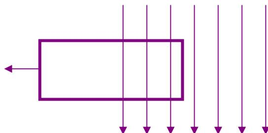
觀察結果：線圈在如圖之磁場中運動時，無感應電流產生
